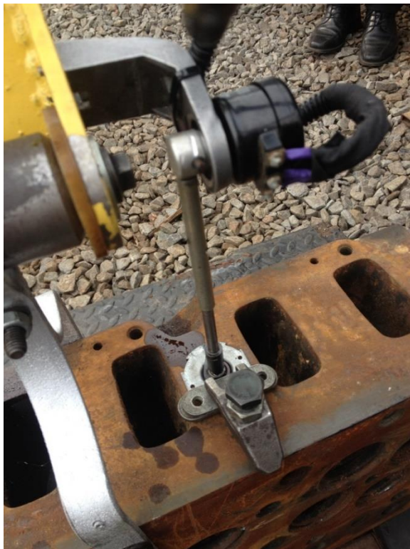
Рис. 4. Датчик кутового відхилення вантажу
