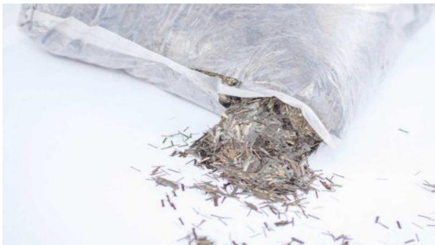
Рис. 2. Модифікована базальтова мікрофібра
