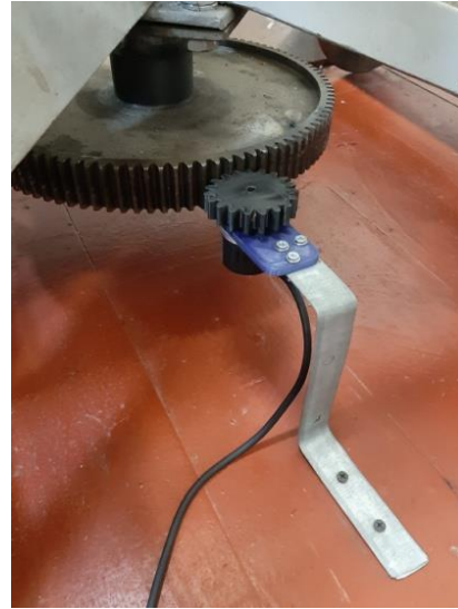
Рис. 5. Інкрементальний енкодер Megatron-Impulsgeber MOL40 6 3600 – BZ N
