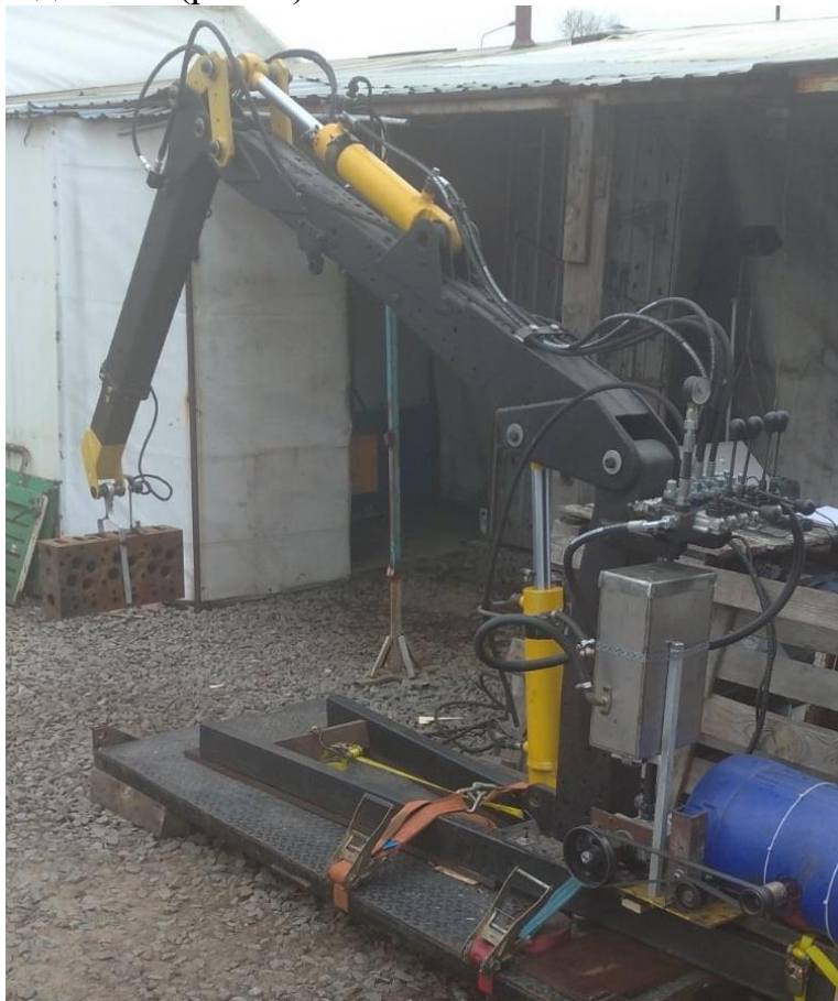
Рис. 1. Експериментальна установка крана-маніпулятора з гідроприводом
