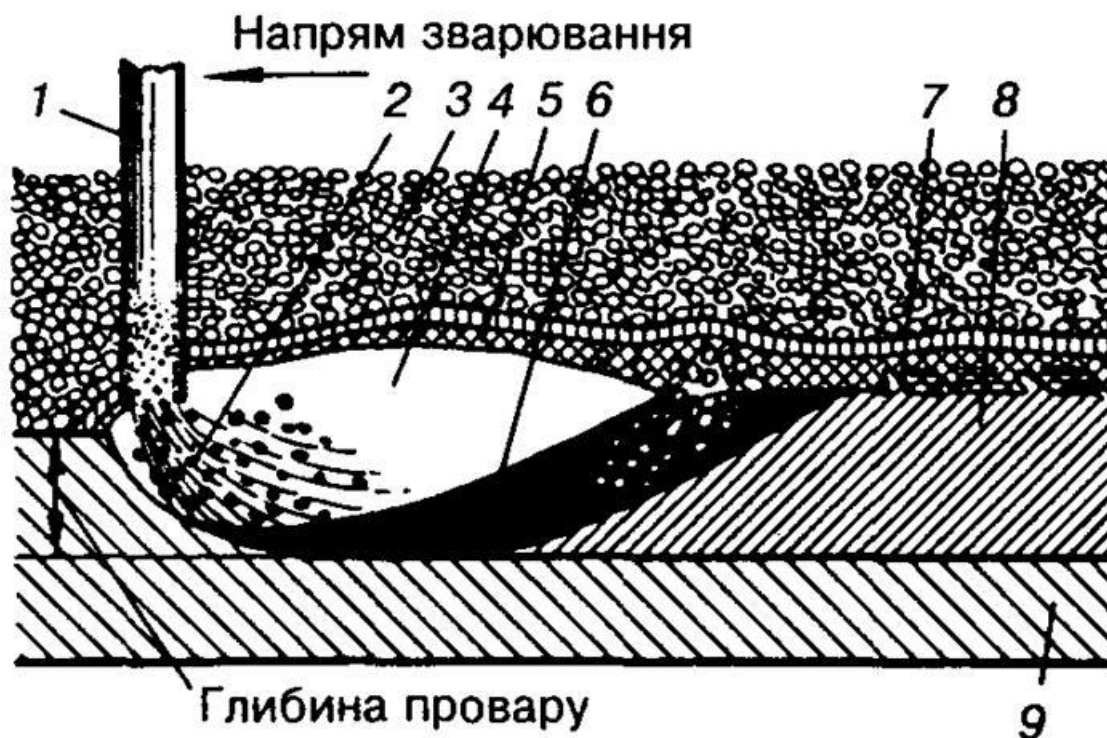
Рис. 17. Схема зварювання під флюсом
