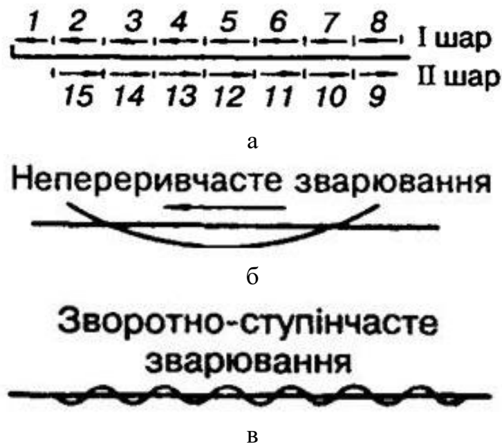
Рис. 43. Зварювання зворотно- методом (а) і порівняння деформації, що виникає при непереривчастому (б) та зворотно- ступінчастому (в) зварюванні
