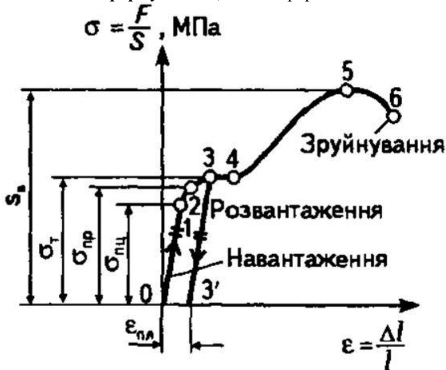
Рис. 1. Діаграма розтягу металевому матеріалу
