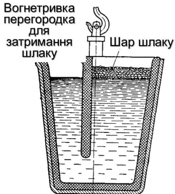
Рис. 31. Чайниковий розливний ківш
