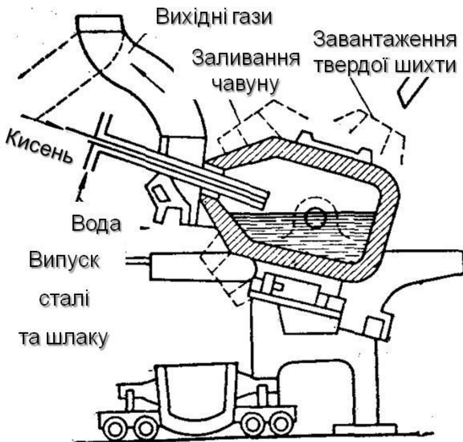
Рис. 21. Схема конвертеру з верхнім кисневим дуттям
