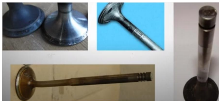
Рисунок 1 – Дефекти клапанів двигунів внутрішнього згоряння.
