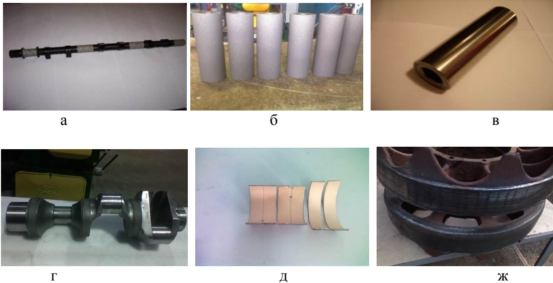
Рисунок 1– Відновлені деталі спеціальної техніки: а) вал розподільний; б) палець поршневий з покриттям; в) палець поршневий після механічної обробки; г) вал колінчастий; д) вкладиш опорної шийки колінчастого вала; ж) коток опорний
