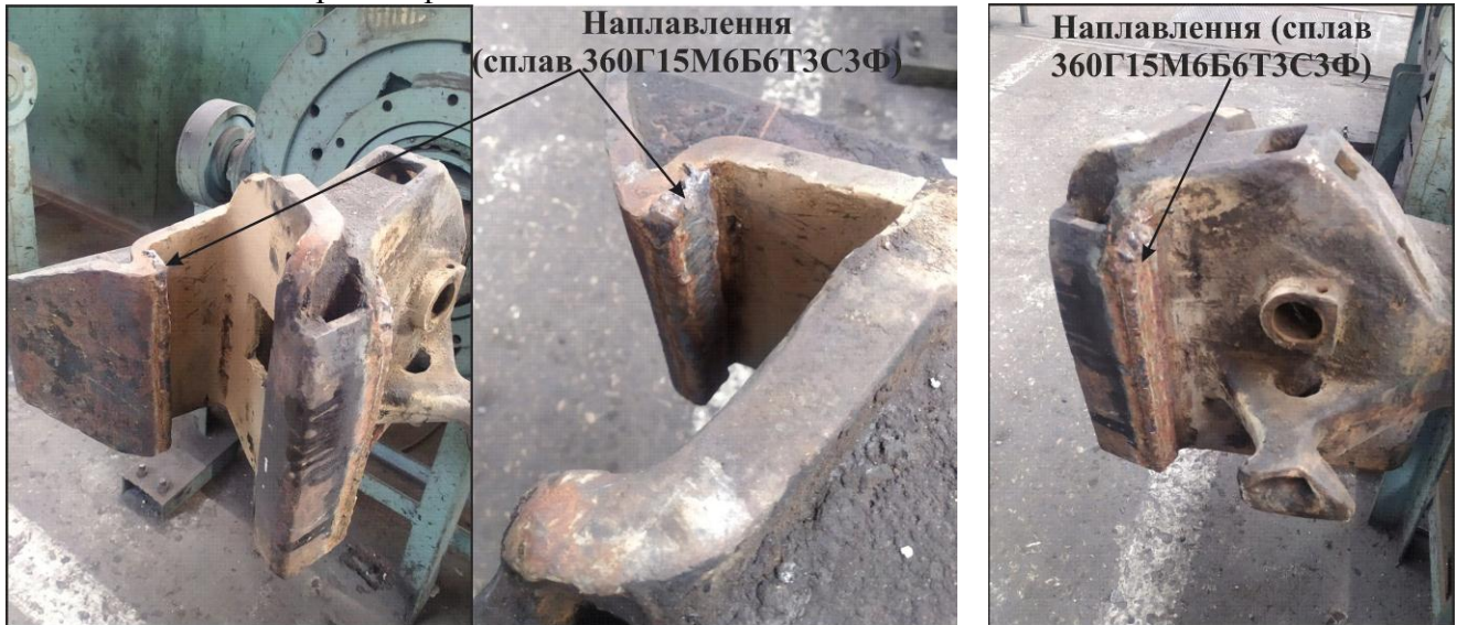
Рисунок 2 – Загальний вигляд відновлених поверхонь автозчепу СА–3
