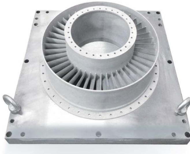
Рисунок 1 – Роздрукований на 3D принтері корпус турбіни двигуна в зборі. IN718 із жаротривкого сплаву 410*240мм
