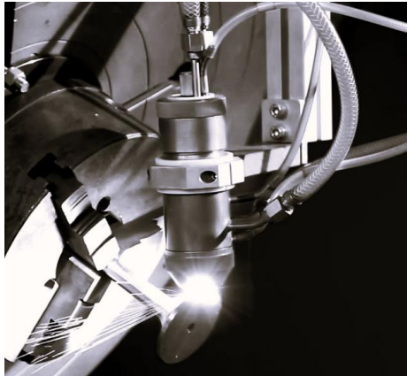
Рисунок 2 – Схема процесу наплення та плазматрон для плазмового наплення клапанів
