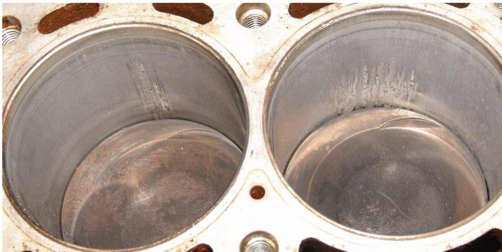
Рисунок 2 – Місця формування задирів в циліндрах двигунів G4KD автомобілів виробництва компаній Kia та Hyundai
