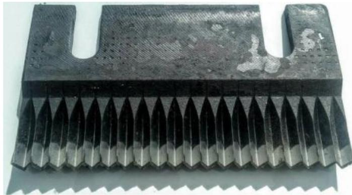
Рисунок 2 – Конструкція ножа відцентрової установки для подрібнення буряків 1011-В
