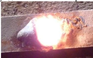
Рисунок 1 – СВС-процес формування композиційного матеріалу 70% (Ti+C+Fe<sub>2</sub>O<sub>3</sub>+Al) + 20% ПГ-10Н-01 + 10% ПТ-НА-01
