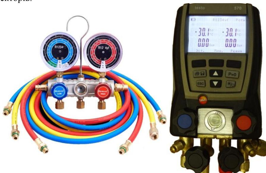
Рисунок 1 – Заправні колектори: зліва - механічний з манометрами для роботи з R1234yf і комплектом шлангів; праворуч - електронний налаштований на роботу з олефіном R1234yf
