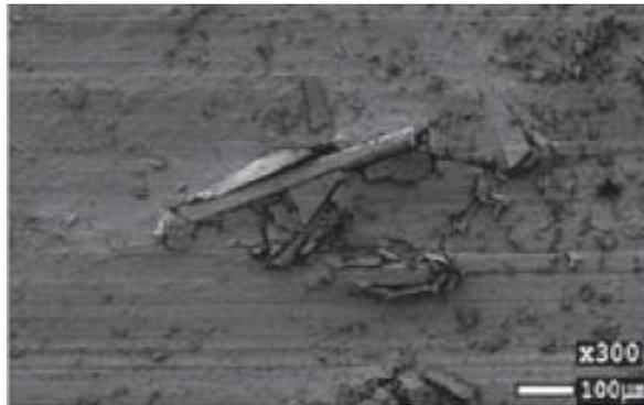
Рисунок 2 – Адгезійні випробування покриття ВПБВ нанесених на поверхню зразку
