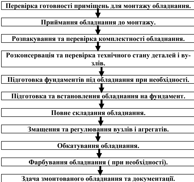
Рис. 1 Зразкова схема технологічного процесу монтажу машин і обладнання.
