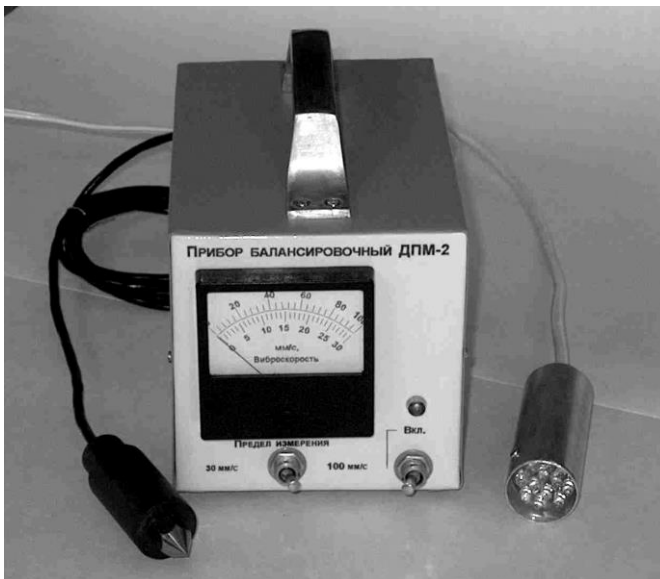
Рис. А.1 Загальний вид приладу ДБ-2К 1 – датчик вібрації, 2 – електронний блок, 3 – стробоскоп.
