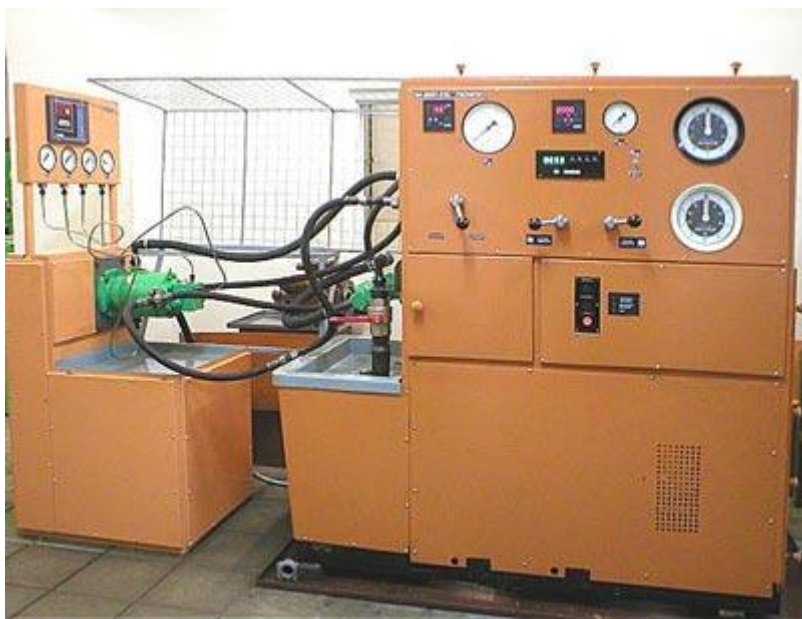
Рис. Д.2 Стенд для випробування аксіально-плунжерних та шестеренних гідроагрегатів ,а також ГСТ-90 КИ-28097-03М ГОСНИТИ
