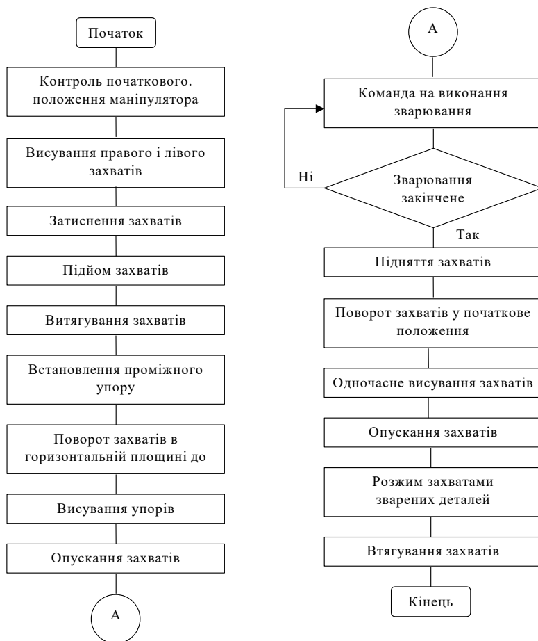
Рис. 5 Приклад блок-схеми роботи ПР зі зварювання деталей
