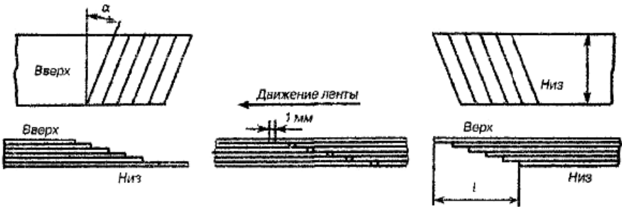
Рис. 11 Схема підготовки стрічки до вулканізації
