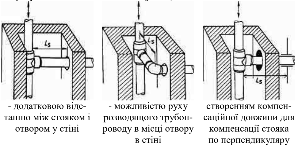
Рис. 7 Компенсація стояків
