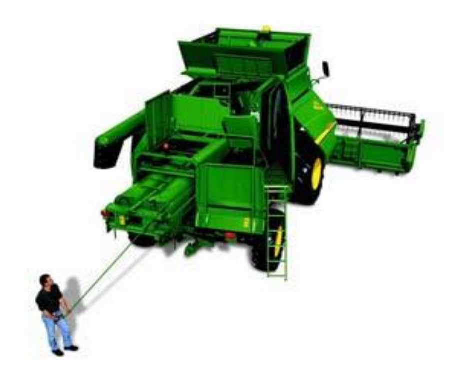
Рис. 12. Проведення ТО вузла роторів комбайна Джон Дір 9780 CTS
