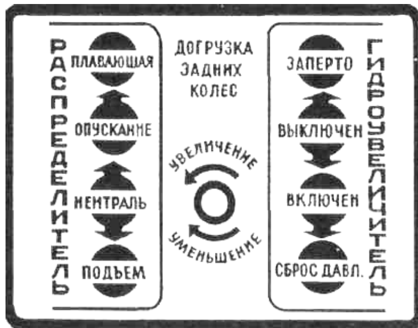
Рис. 2. Схема керування гідравлічною системою тракторів МТЗ
