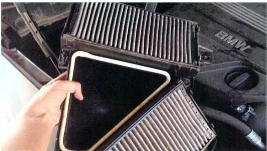
тиляції МЕЗ не здатна створити настільки сильну тягу, яку забезпечує розрідження у впусковому колекторі двигуна. До недоліків пилових салонних фільтрів слід віднести неможливість очищення повітря від токсичних газів і неприємних запахів.
