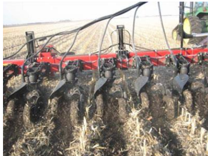
Рис. 1. Робота ґрунтообробного знаряддя за технологією STRIP-TILL.
