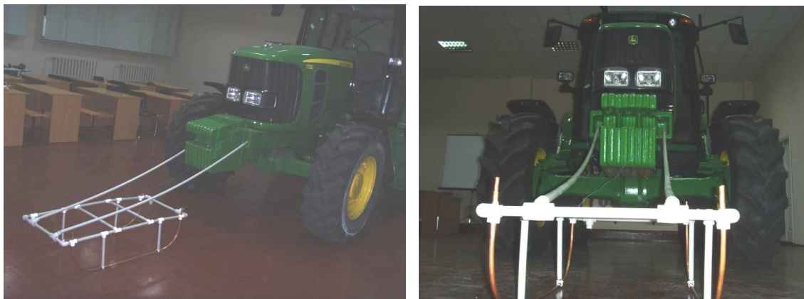
Рис. 2. Загальний вигляд пристрою для моніторингу варіабельності стану ґрунтового середовища на транспортному засобі.
