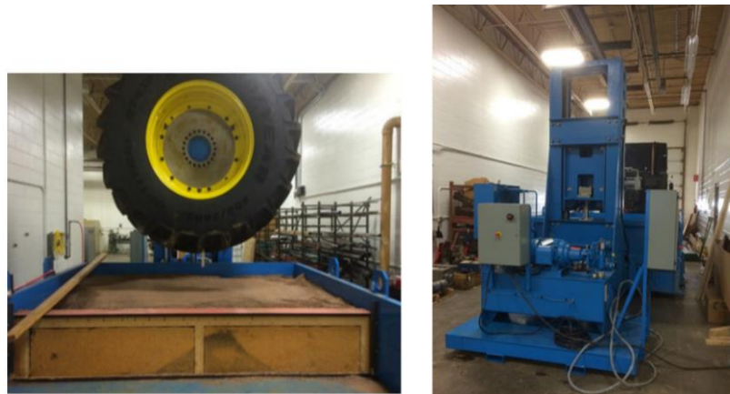
Рис. 2. Система статичного навантаження колеса.
