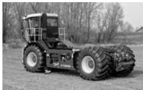
Рис. 1. Багатоцільові несучі самохідні шасі: а, в – принципова схема; б, г – загальний вигляд; 1, 2, 3 – зони розташування технологічних модулів.
