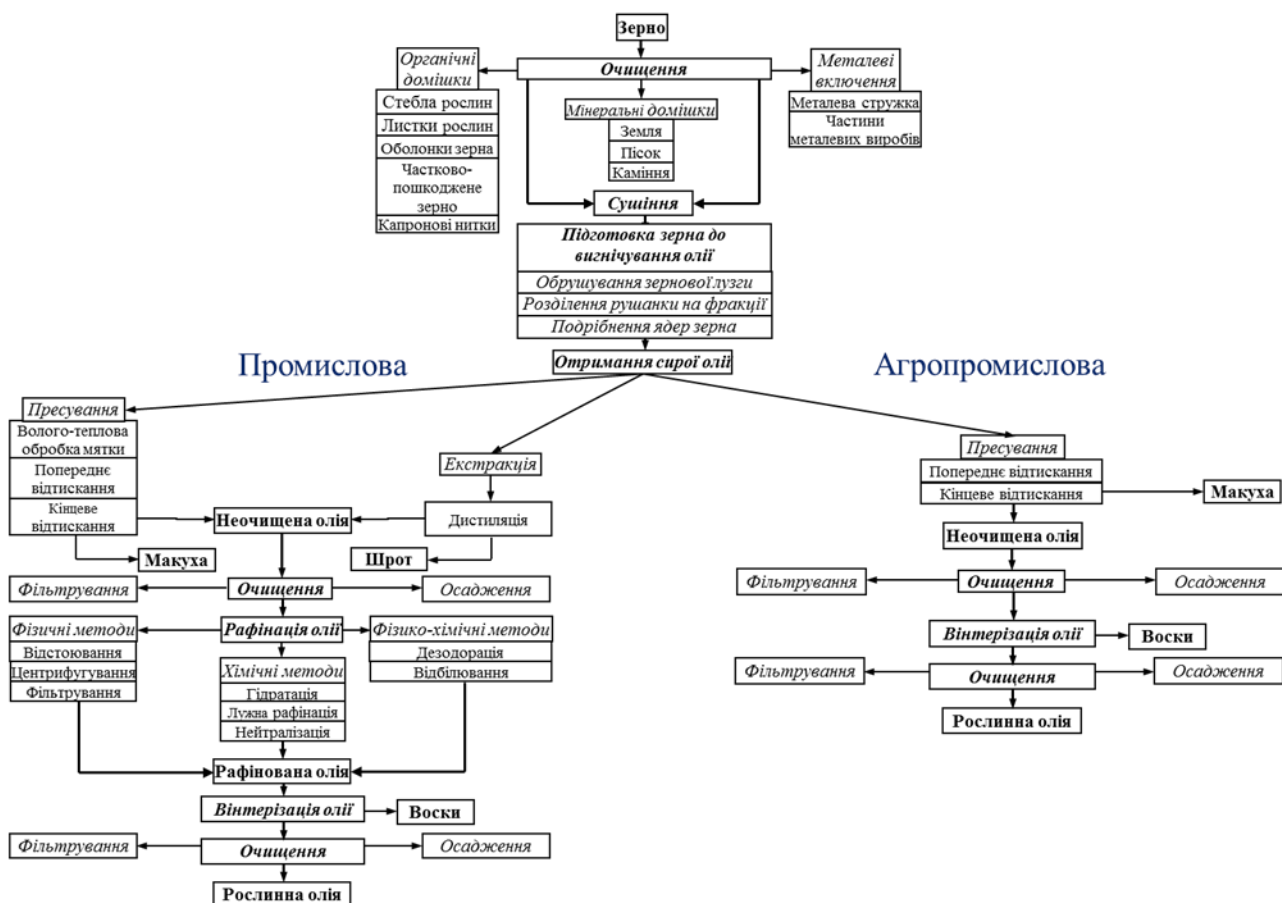
Рис. 1. Схема виробництва рослинної олії.
