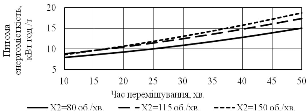
Рис. 2. Залежність питомої енергомісткості процесу від часу перемішування при температурі суміші 25 °С.
