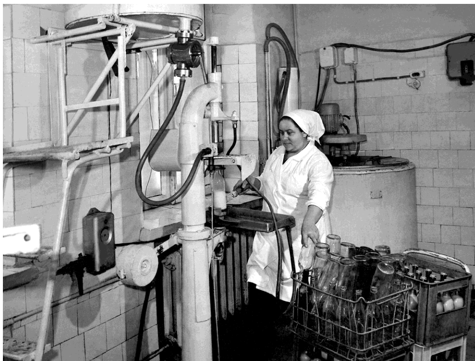
Рис. 5.1. Розливання та укупорювання кумису в цеху
