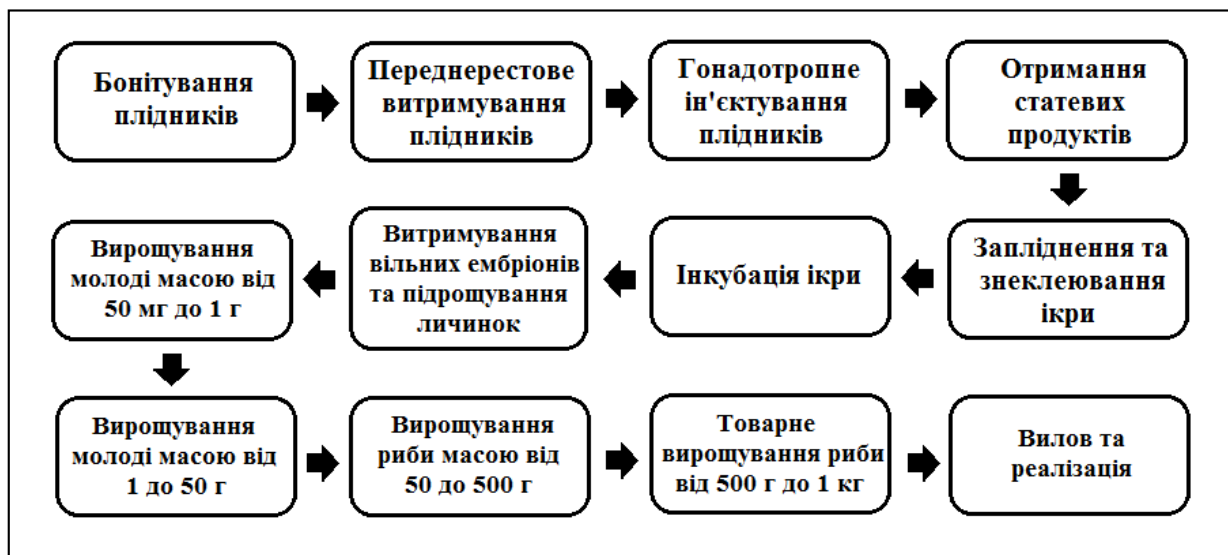
Рис. Технологічний процес повноциклового вирощування кларія в УЗВ
