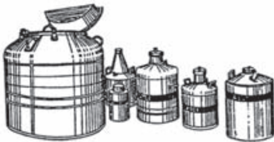
Рис. 32. Посудини Дьюара для стаціонарного зберігання сперми: зліва – посудина KV-6202, решта – посудина AT-7, “Харків-30”, СД-50, СД-20 та AT-6.
