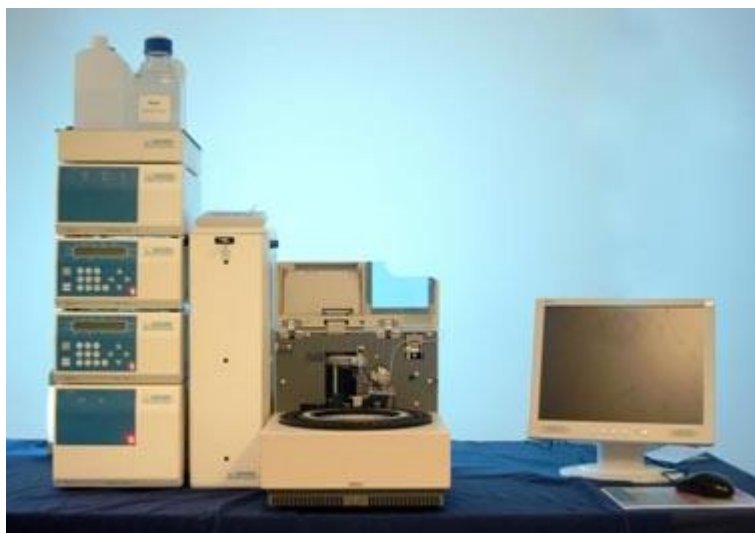
Рис. 2. Аминокислотный анализатор нового поколения
