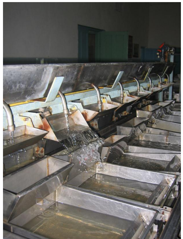
Мал. 81. Інкубаційний апарат «Осетер»
