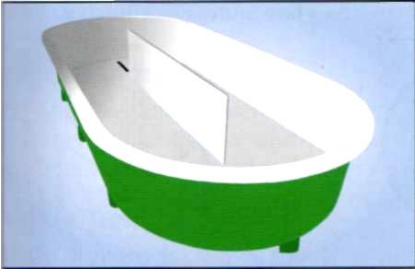
Мал. 54. D-подібний басейн без опірної конструкції, з приямок для фекалій, стічною трубою та перегородкою
