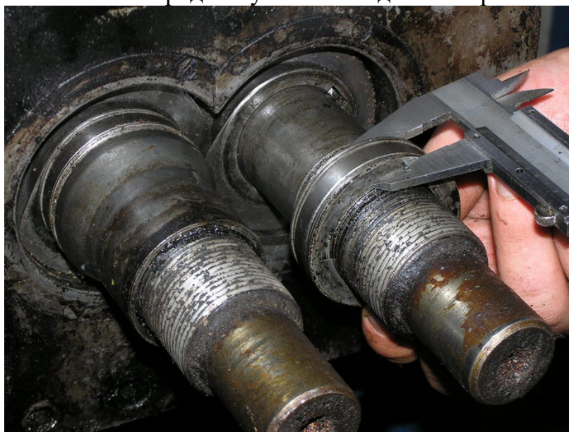
Рис. 2. Визначення товщини групи компенсаційних кілець для регулювання зазору в матриці прес-екструдера
