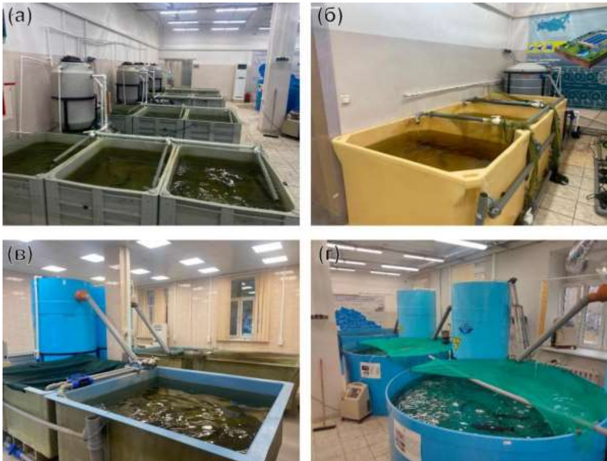
(а, б) – баки для проведення експериментальних робіт, лінія 4+1 з баками об'ємом 750 літрів (усього 12 баків); (в, г) – ємності для утримання риб об'ємом 3000 л
