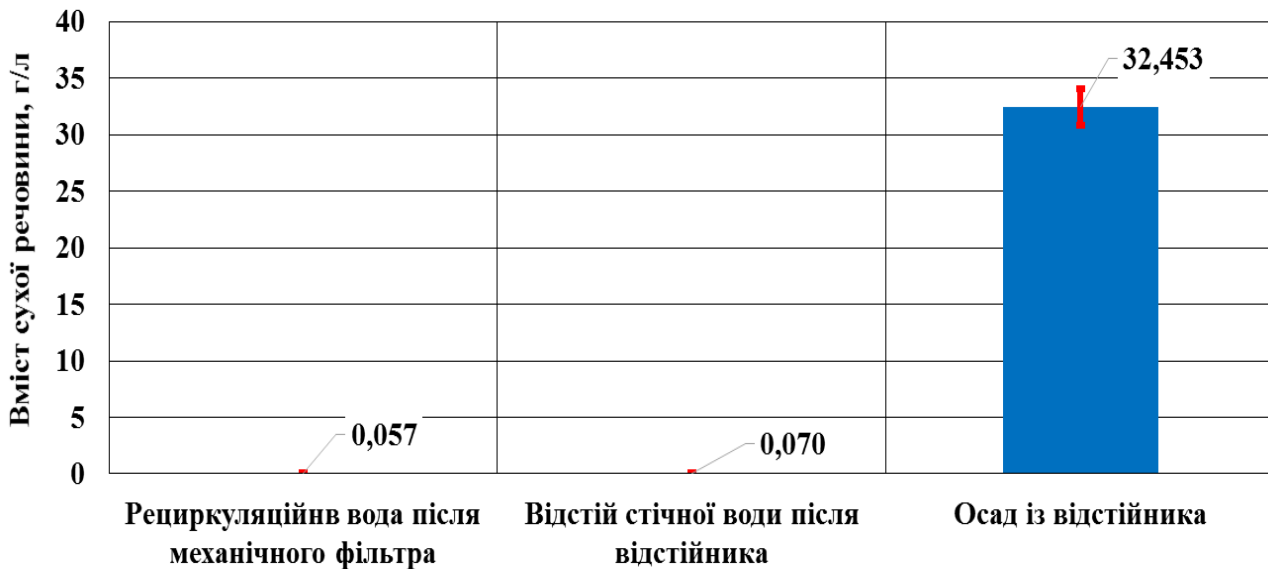
Рис. 4.5. Розподіл вмісту твердих речовин у рециркуляційній воді після механічного фільтра, відстоюній стічній воді після відстійника та осаді із відстійника при відстоюванні упродовж доби
