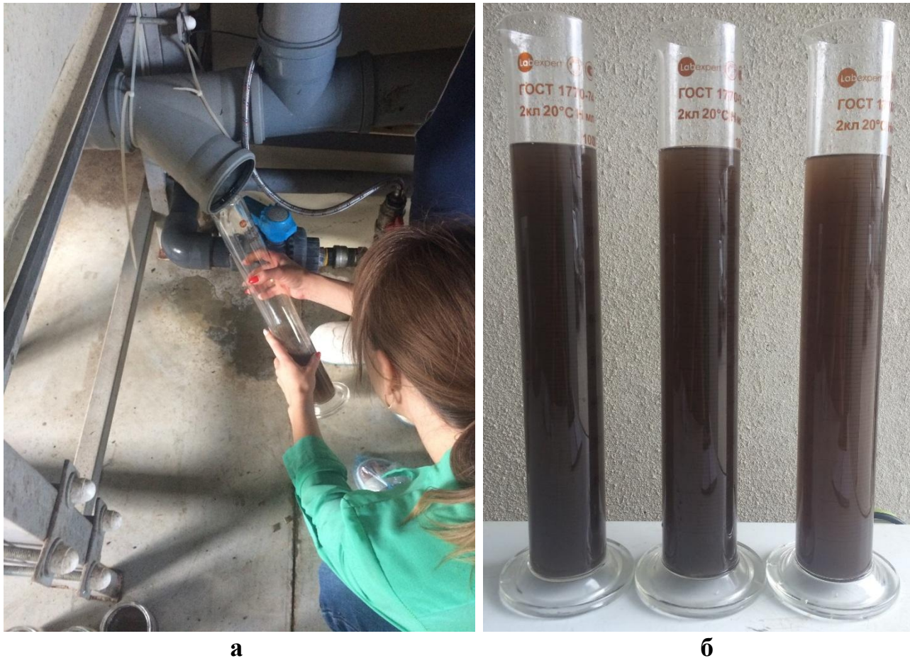
Рис. 3.5. Загальний вигляд місця відбору проб стічної промивної води стічної (а) та промивної води із механічного фільтра (б) в мірних циліндрах
