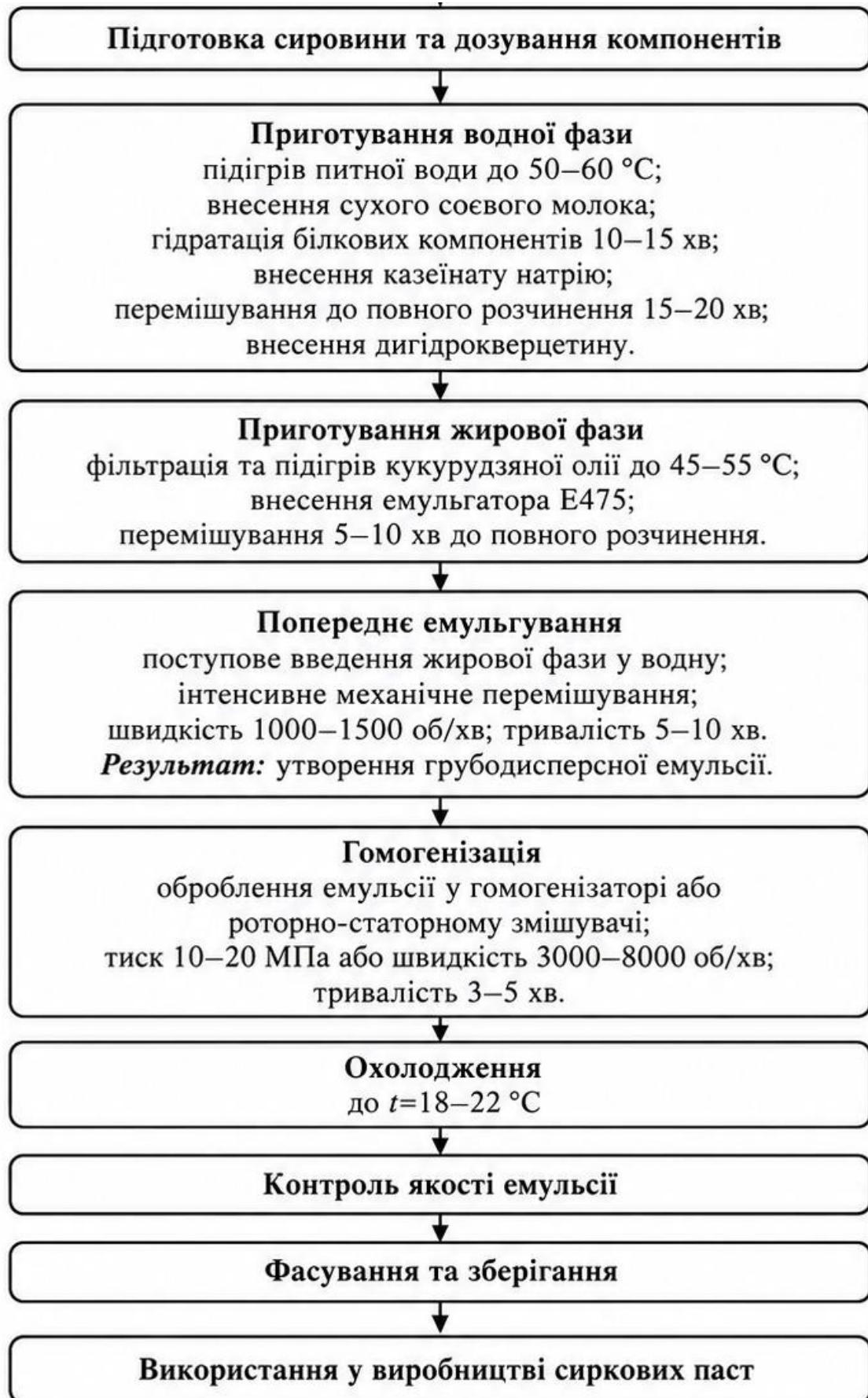
Рисунок 3.7 - Технологічна схема виробництва соєво-жирового концентрату
