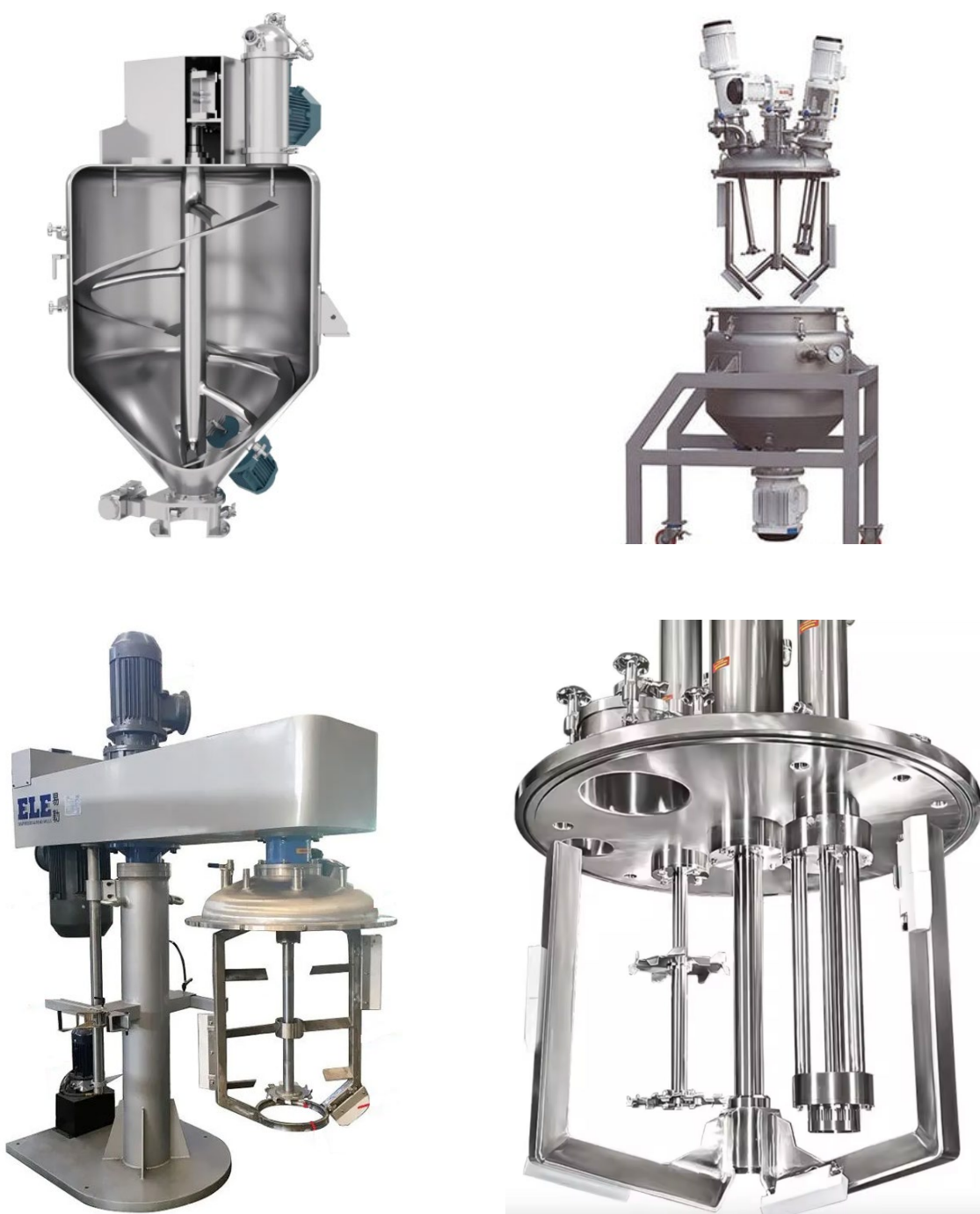
Рисунок 1.1. Загальний вигляд лопатевих та рамних змішувачів для високов'язких середовищ
