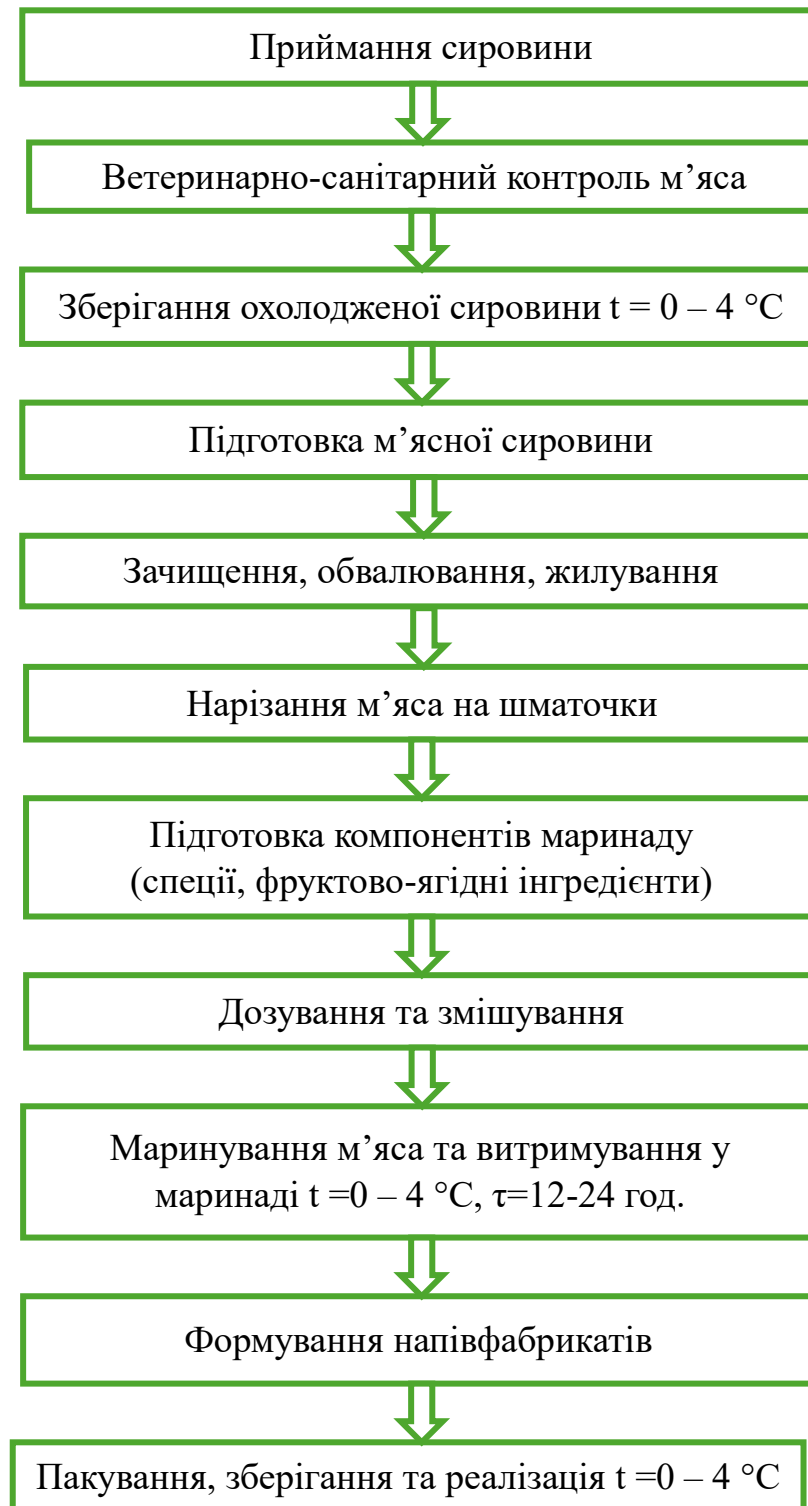
Рисунок 4.1. Удосконалена технологічна схема виробництва натуральних маринованих напівфабрикатів з м'яса дикого кабана із фруктово-ягідними інгредієнтами
