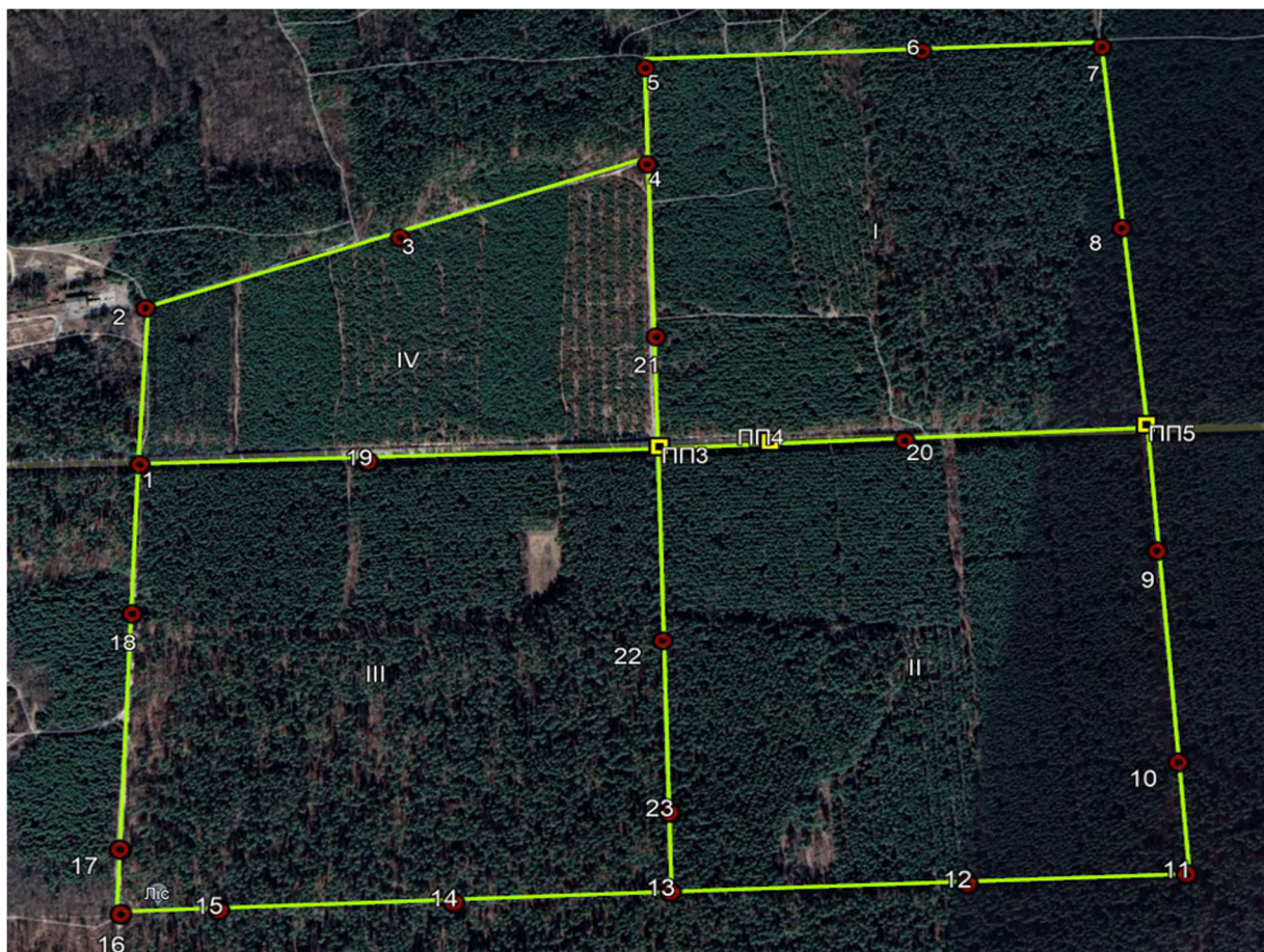
Рис. 2.10. Схема закріплень межових точок для вимірювання площі дослідних лісових землекористувань на основі GNSS – спостережень*
