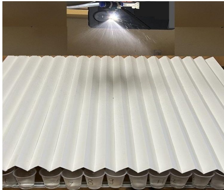
Рис.Ж. 4. Фотографія лабораторного стенда для визначення спектра розпилення за допомогою гофрованого столу та мірних ємностей
