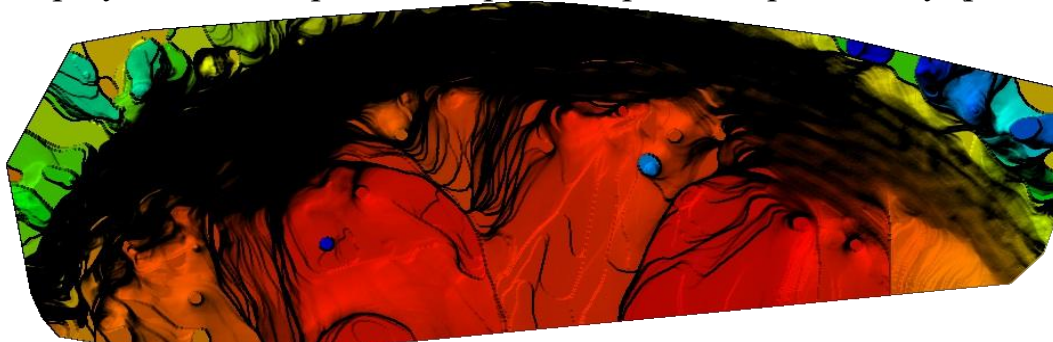
Рис. 3 Ортомозаїка та відповідна розріджена цифрова модель поверхні (DSM) до ущільнення.
