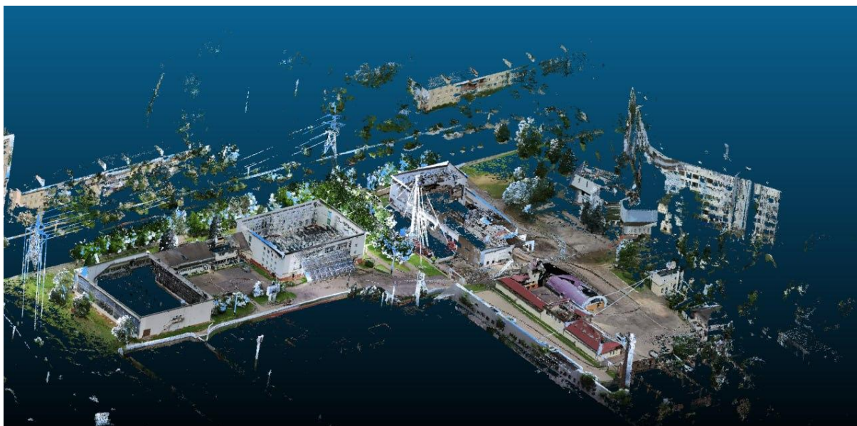
Рис. 2 Кольоризована хмара точок пошкоджених будівель ІФНТУНГ
