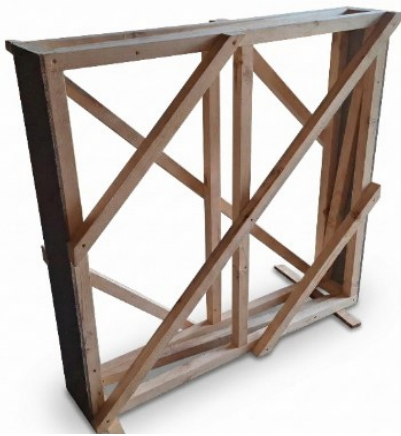
Рис.1 Загальний вигляд СДККТ з целюлозним наповнювачем де: а – каркас СДККТ; б – СДККТ з целюлозним наповнювачем та обшивкою OSB плитою
