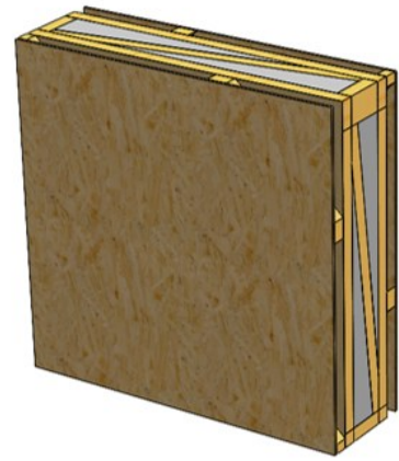
Рис.1 Загальний вигляд СДККТ з целюлозним наповнювачем де: а – каркас СДККТ; б – СДККТ з целюлозним наповнювачем та обшивкою OSB плитою
