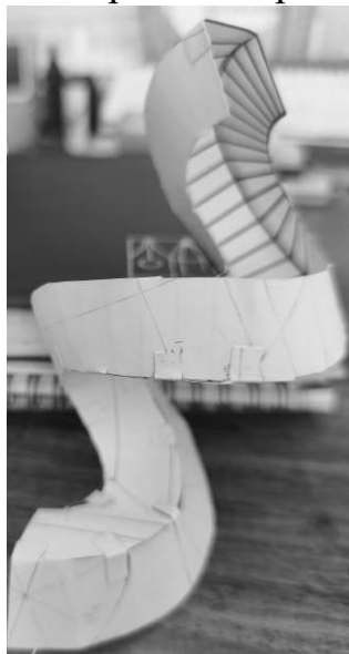
Рис. 4. Натурна модель, виготовлена з'єднанням розгортки окремих смуг
