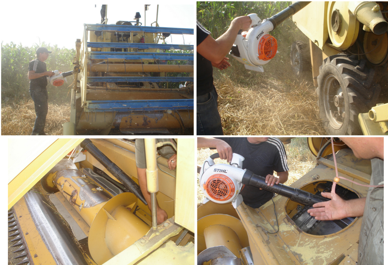
Рис. 5.7. Обов'язкова очистка зернозбиральної, посівної техніки від насіння попередньої культури
