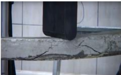
Балка після підсилення: 5.4 кН
