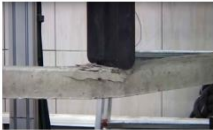
Балка до підсилення: 3.8 кН
