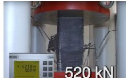
Призма після підсилення: 520 кН
