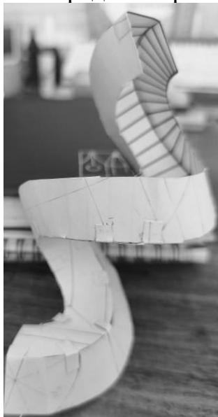
Рис. 4. Натурна модель, виготовлена з'єднанням розгортки окремих смуг
