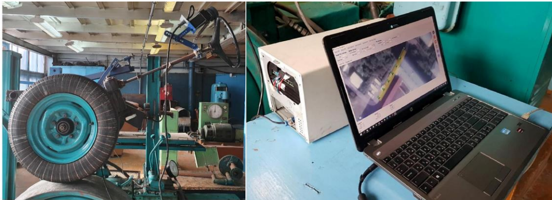
Рисунок 1 – Експериментальний стенд з керуючим електродвигуном та ПК із програмою управління та блок, що інтегрує в собі апаратні компоненти системи управління
