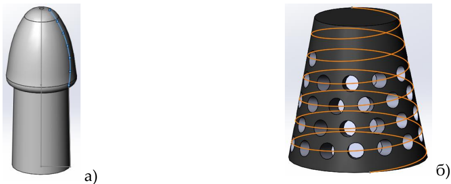
Рисунок 1. Особливості конструкції зубчастих конусних коліс: а – утворення робочої поверхні зубця; б – схема розміщення отворів для встановлення зубців
