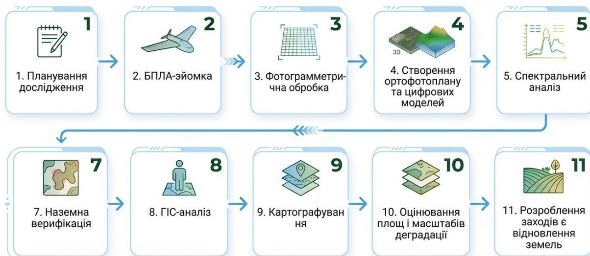
Рисунок 1. Технологічна схема моніторингу сільськогосподарських земель
