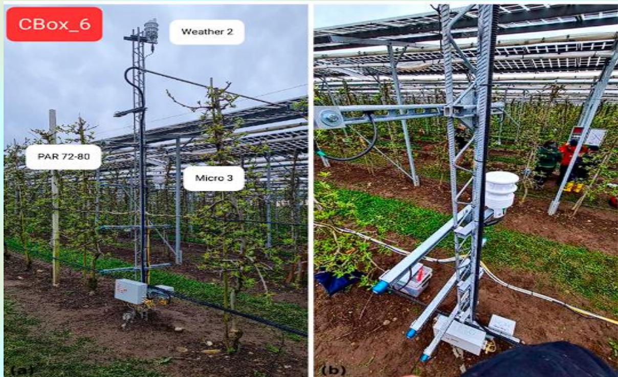
Рис.1. Розташування метеостанції (2; висота 5 м) та мікрокліматичної станції (3; висота 2 м) у Крессбронні
