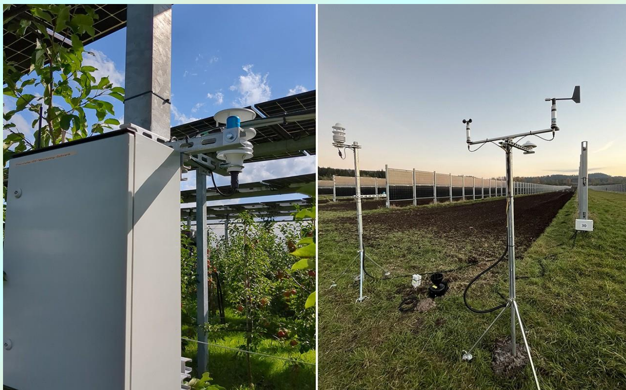
Рис. 2. Станції моніторингу агровольтаїки в експлуатації: в Нуссбаху (ліворуч) - шафа керування з реєстратором даних, датчиком PAR та мікрокліматичною станцією; у Донауешингені (праворуч): анемометр, метеостанція, ґрунтовий зонд та опадомір (джерело: https://www.ise.fraunhofer.de/en/business-areas/solar-power-plants-and-integrated-photovoltaics/integrated-photovoltaics/agrivoltaics.html )
