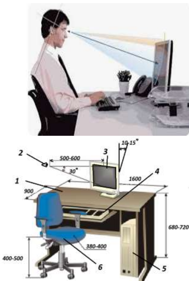
Рисунок – Схема організації робочого місця користувача комп'ютером та розміщення обладнання: 1 – комп'ютерний стіл; 2 – очі користувача; 3 – плоский монітор; 4 – клавіатура; 5 – систем блок; 6 – стілець користувача.
