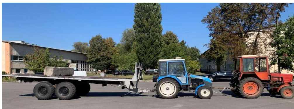
Рис. 1. Експериментальний машинно-тракторний агрегат з автоматизованим енергомодулем
