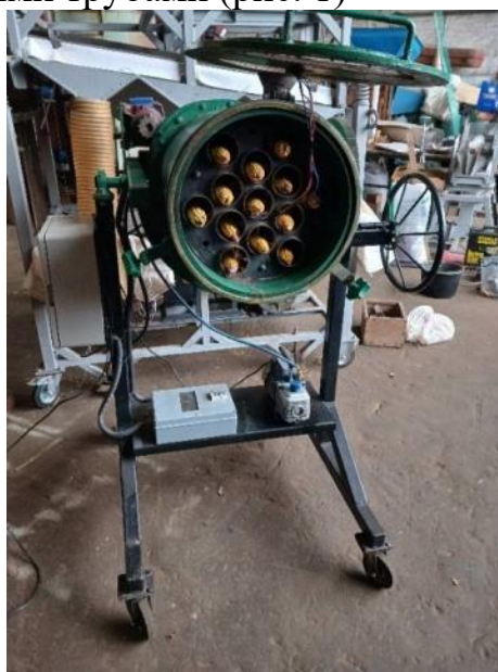
Рис. 1 Загальний вигляд експериментального зразка вакуумної барабанної сушарки
