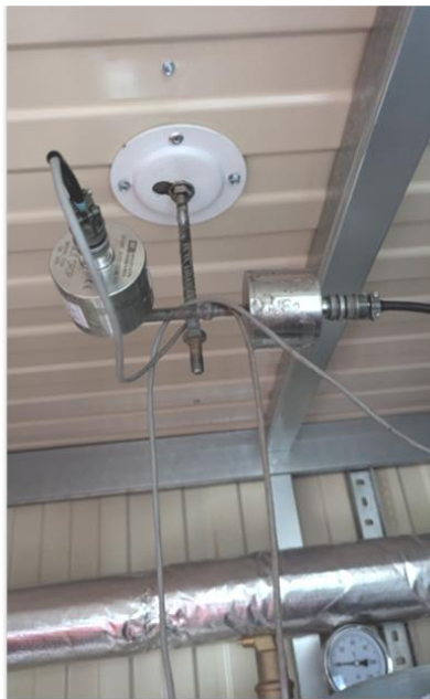
Рис. 2. Датчики прискорень встановлено на конструкціях стелі будинку (а) та два модульних будинка на платформі трейлера перед початком динамічних випробувань при перевезенні (б)
