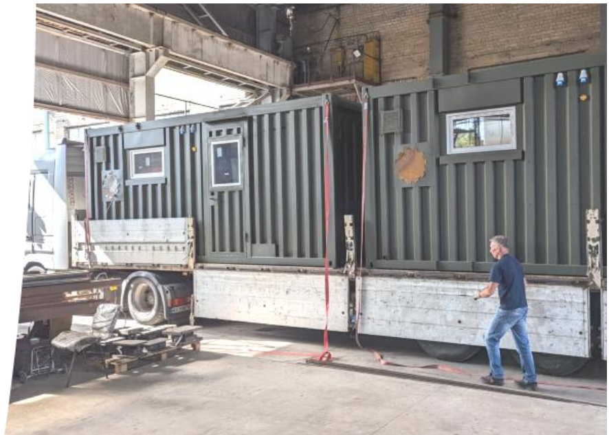
Рис. 2. Датчики прискорень встановлено на конструкціях стелі будинку (а) та два модульних будинка на платформі трейлера перед початком динамічних випробувань при перевезенні (б)
