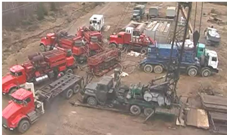
Рисунок 1. Проведення промислових випробовувань на базі мобільного агрегату для гідравлічного розриву пластів мод. Halliburton Tier IV DGB на шасі Мерседес 4150 (8x8)
