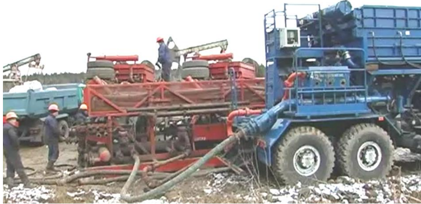
Рисунок 1 – Проведення промислових випробовувань на базі мобільного агрегату для гідравлічного розриву пластів мод. FC-2251
