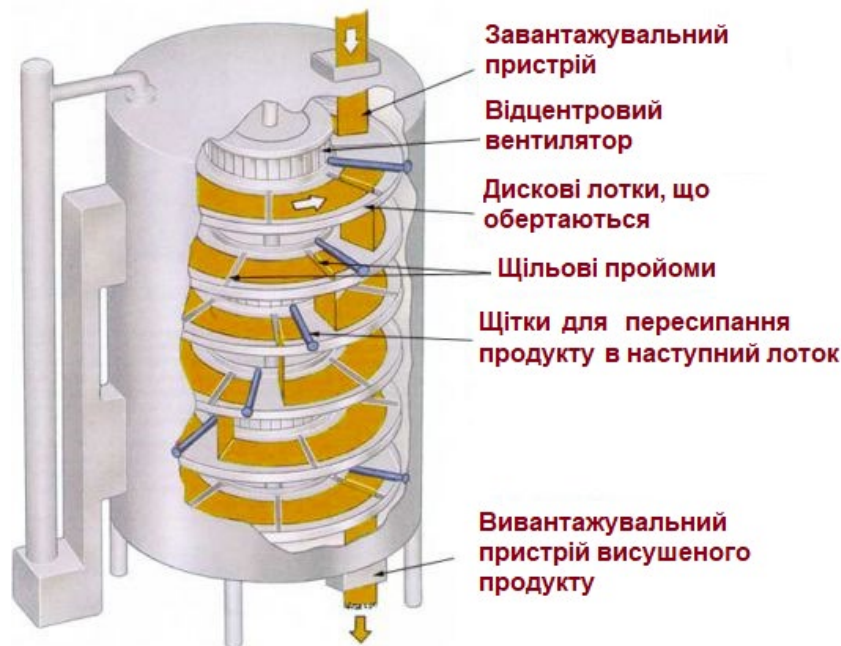
Рис. 1. Техніко-технологічна схема карусельно-тарілчастої сушарки
