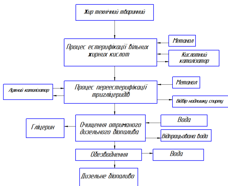
Рис.1. Технологічна схема виробництва дизельного біопалива [1-3]
