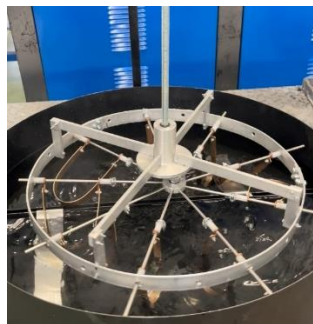
Рис.2 – Робоче колесо теплового двигуна горизонтального типу з елементами із сплаву Camital [4]
