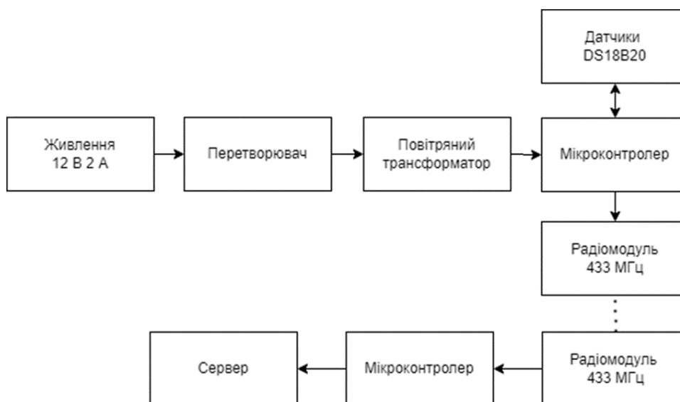
Рис. 2. Блок-схема системи вимірювання і передавання поточних даних стану обертової частини ПЕМП
