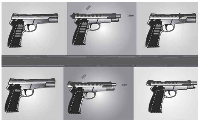
Мал 3.2.5 Рух затвору пістолету після пострілу
