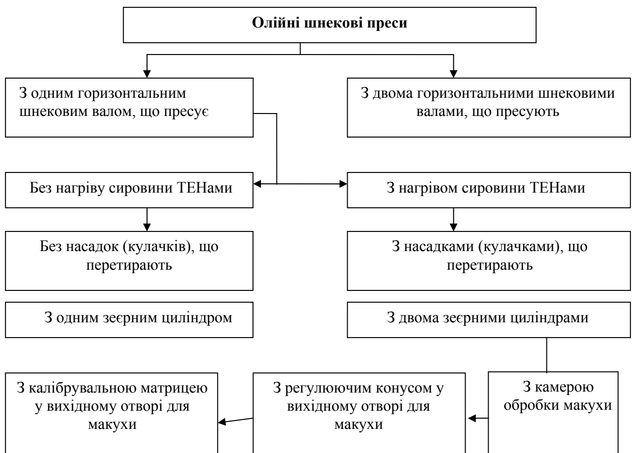
Рисунок - Класифікація основних типів олійних пресів зі шнековими робочими органами
