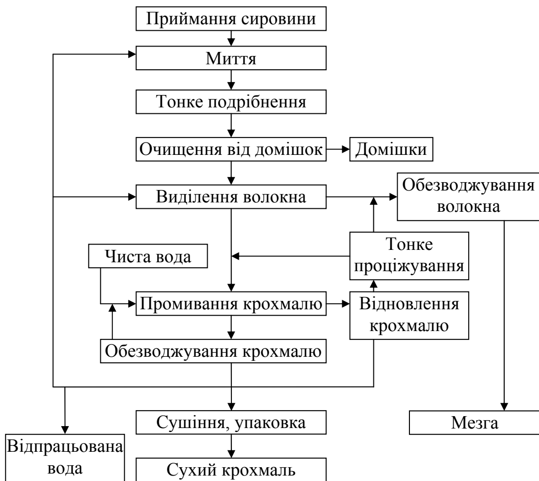
Рис. 1. Технологічна схема виробництва крохмалю
