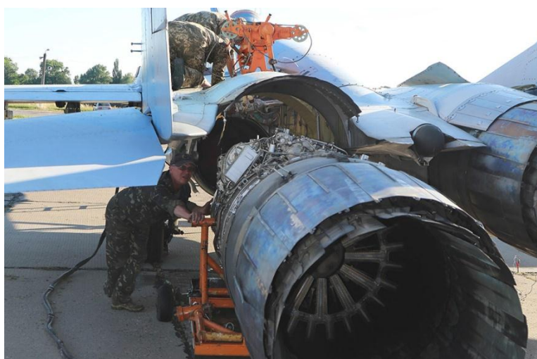
Рис. 2. Часткове розбирання АТ для доступу до систем і агрегатів
