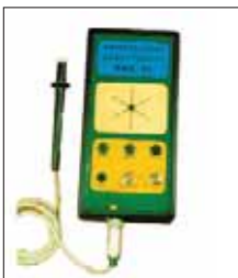
Рекомендований прилад дефектоскопічного контролю для виявлення тріщиноподібних дефектів у відповідальних деталях вузлів тракторів класу 1.4
