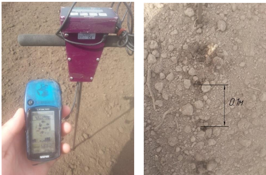
Рис. 1. Робота із пенетрометром FIELDSCOUT SC 900.
