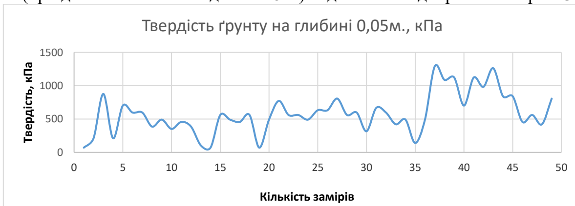
Рис. 3. Твердість ґрунту на глибині 0,05 м, кПа.
