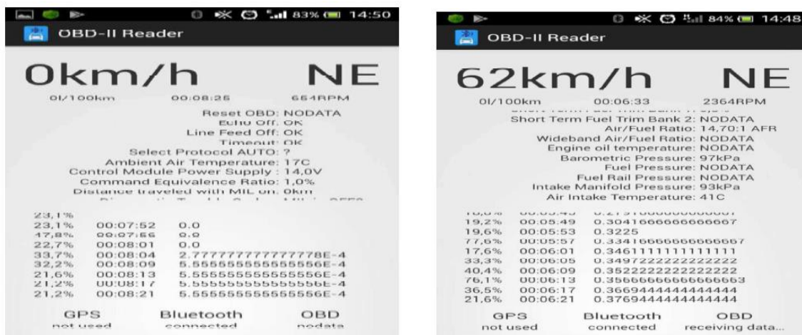
Рис. 1. Перший запуск програми (а) та вимірювання навантаження двигуна під час руху (б).
