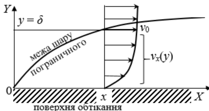
Рис. 1. Розподіл швидкостей на поверхні обтікання за турбулентного пограничного шару.
