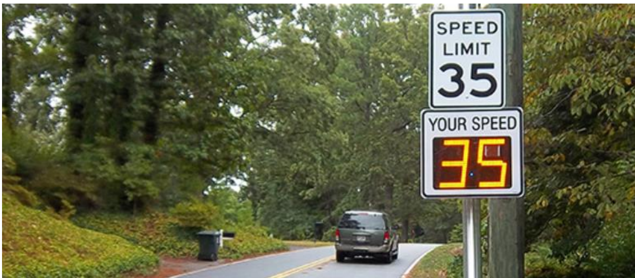
Рис. 5. Пристрій керування дорожнім рухом, який призначений для надання повідомлення водіям, що перевищують певний поріг швидкості
