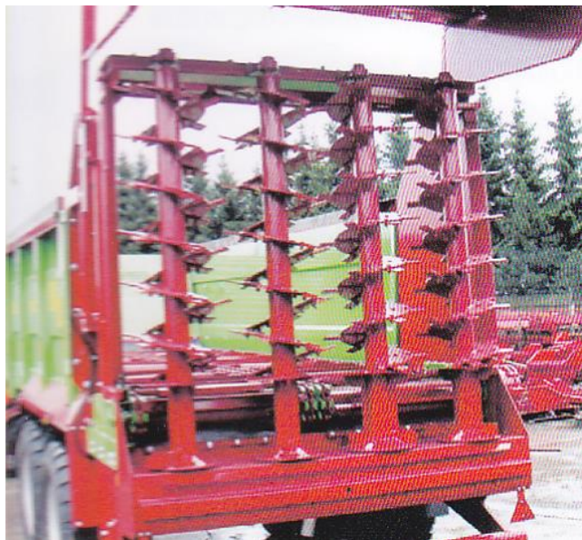
Рис. 2. Шнековий розкидальний робочий орган з вертикальною віссю обертання
