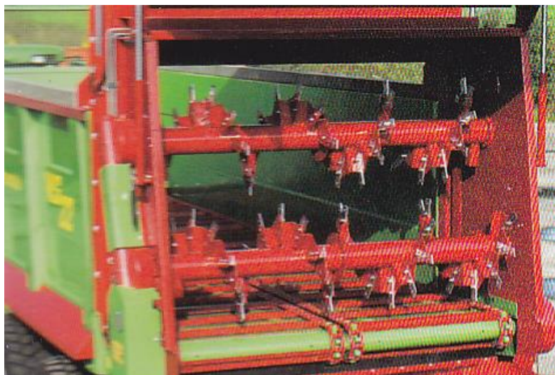
Рис. 1. Шнековий розкидальний робочий орган з горизонтальною віссю обертання.
