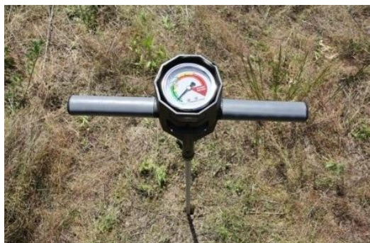
Рис. 2. Пенетрометр механічного типу. Без прив'язки до GPS.
