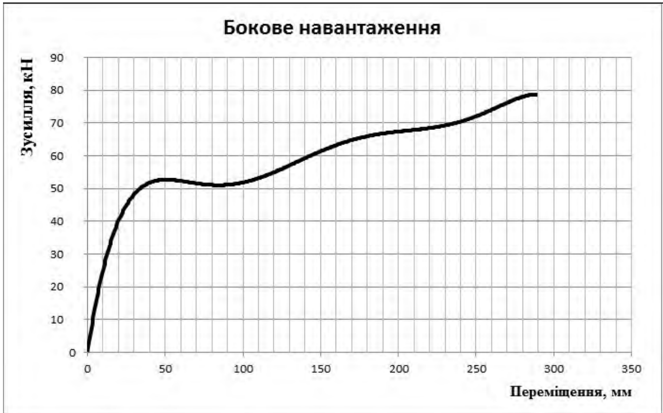
Рисунок 3 – Крива «зусилля-переміщення» під час навантажування збоку
