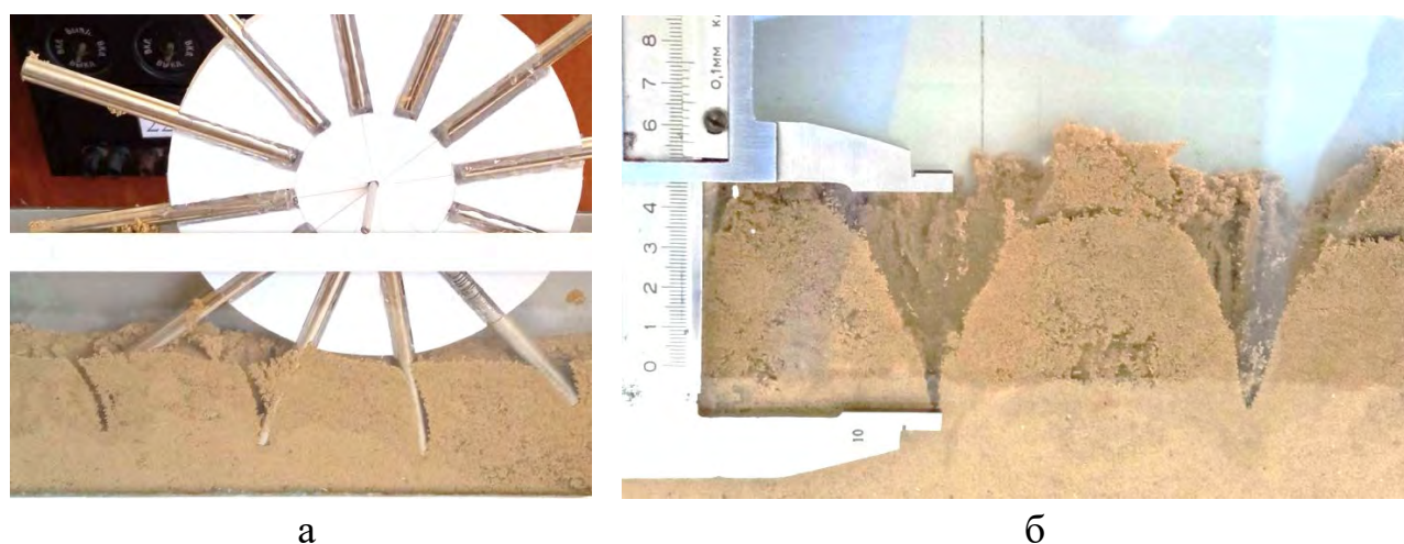
Рисунок 3 – Приклад моделювання взаємодії з шаром ґрунту голчастого ротаційного знаряддя у ґрунтовому каналі: а – вигляд моделі знаряддя в каналі; б – чисельне визначення деяких параметрів
