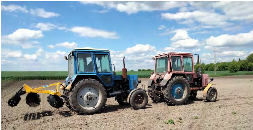
Рисунок 2 - Проведення тягових випробувань дискової борони GiaRDino
