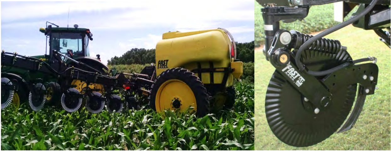
Рисунок 2 – Знаряддя Fast 8000N Series для внесення ріднини в шар ґрунту [4]: а – вигляд рядкового внесення; б – вигляд робочого органа
