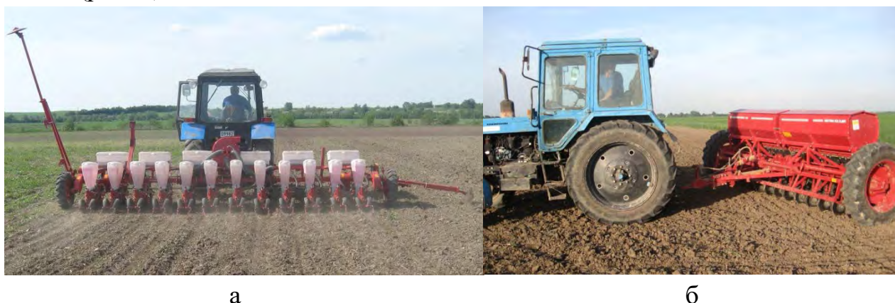
Рисунок 1 – Сівба насіння світчграсу просапною сівалкою УПС-12 (а) та зерною ASTRA 3,6A-06 (б)
