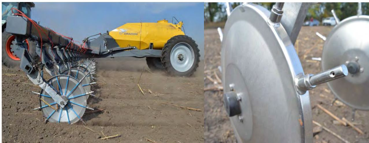
Рисунок 1 – Знаряддя «Dragon» для внесення рідини в шар ґрунту [8]: а – вигляд в процесі внесення; б – вигляд робочого органу
