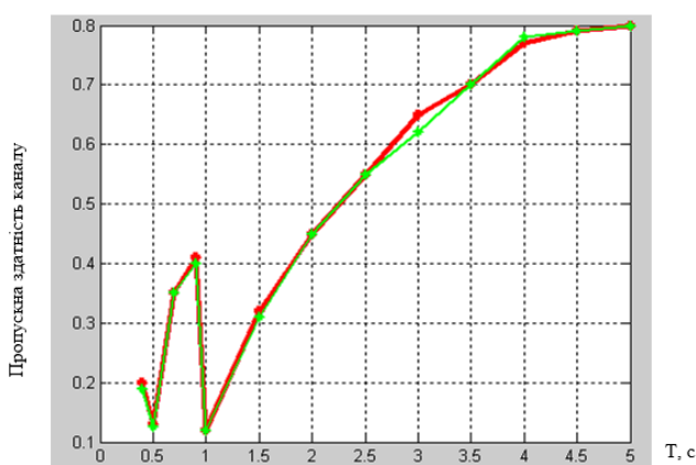
Рис. 4.25. Нормалізована пропускна здатність множини потоків від періоду атаки T
