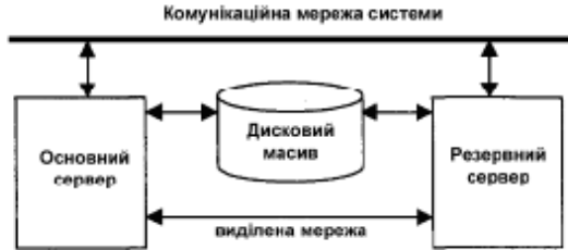
Рис. 2.37 Гарячий резерв Реплікація. Структура системи з копіюванням (реплікацією) даних показана на рис. 2.38.
