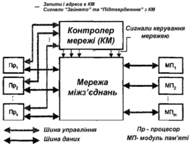
Рис. 2.17 Структура мережі з централізованим управлінням
