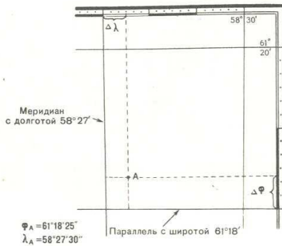
Рис. 6.16. Опреділення географічних координат пункту А на топографічній карті. Пунктирними лініями надані паралель і меридіан, проведені крізь дану точку
