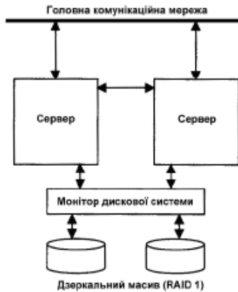
Рис.2.39 Відмовостійка реалізація паралельного сервера БД
