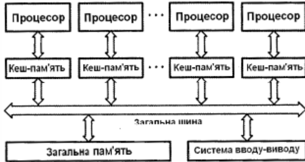
Рис. 2.5. Структура SMP-системи із загальною шиною
