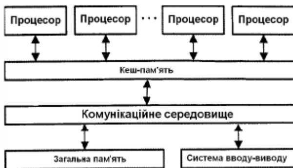
Рис. 2.4. SMP-система із спільно використовуваною кеш-пам'яттю
