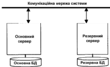
Рис. 2.38 Відмовостійка система з реплікацією
