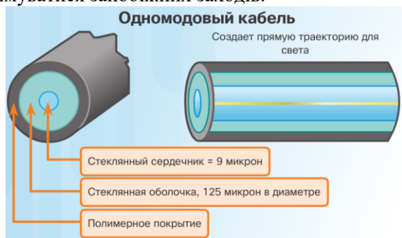
Рис. 1.1.38 Будова одномодового оптоволоконного кабеля
