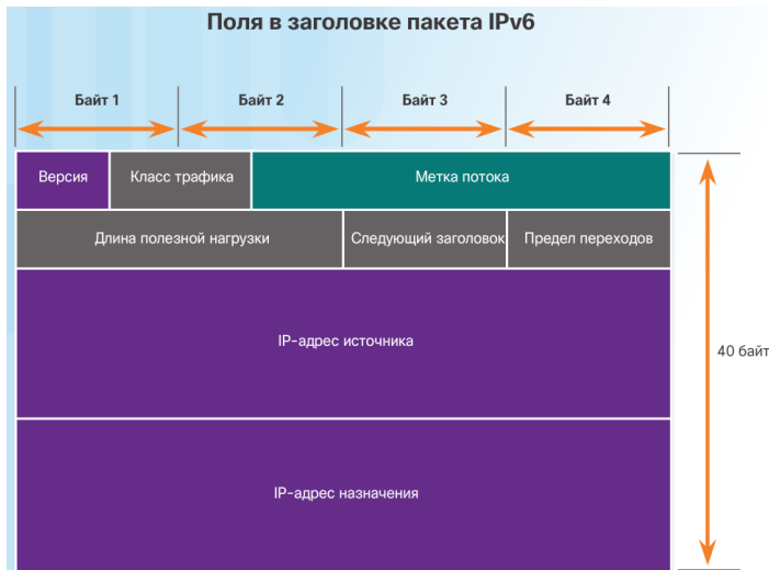
Рис. 1.3.8 Поля заголовку IPv6
