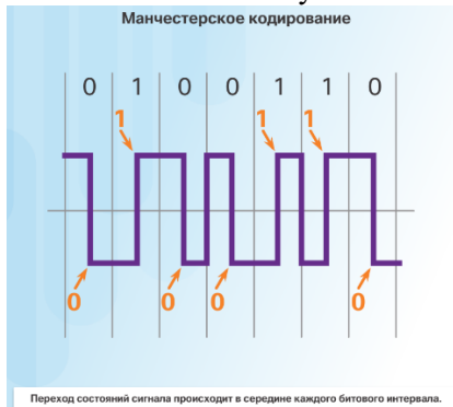
Рис. 1.1.28 Манчестерське кодування
